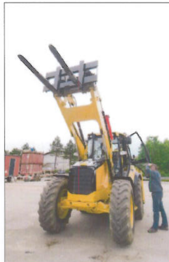
Udsynet til pallegafflerne er fint i højden. Ved jorden kniber det til gengæld.
